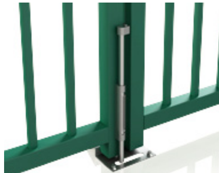
RYGIEL - w bramie ręcznej stanowi pewną blokadę skrzydła mocowaną do fundamentu.
