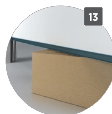
Überlastungssicherung Sollte der untere Sektionrand des automatisches Tores auf ein Hindernis treffen, stoppt der Überlastungsschutz den Türflügel und reversiert.
