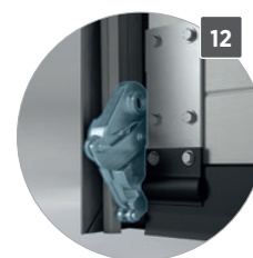
Seilbruch-Sicherung Verhindert das Herabfallen des Türflügels im Falle eines Seilbruchs - Standard bei allen UniTherm-Toren.
