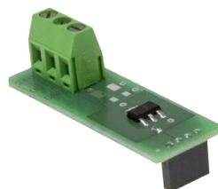
Zusatzplatine mit Signalausgang. Information über die Torposition: Tor zu (NO)/Tor nicht zu (NC). Kann an kabelgebundene Smart-Home-Systeme angeschlossen werden.
