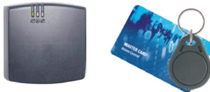
Ermöglicht die Steuerung mit Näherungskarten oder Näherungsanhängern. Halten Sie die Karte / den Anhänger einfach in die Nähe des Lesers, um den Torantrieb zu aktivieren.
