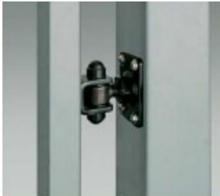
SCHARNIER AN DER MONTAGEPLATTE - ermöglicht die Montage des Tores an vorhandenen Stahl- oder Betonpfosten (Option).
