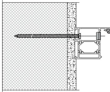
Pose directe au moyen de vis en acier trempé à travers le bâti.
