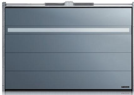
Hliníkový panel bez tepelné izolace nebo a s tepelnou izolací, pro vrata s  $So \leq 3000$  bez mřížek, pro vrata s  $So > 3000$  s jednou mřížkou. Výška panelu Horizon 215-250 [mm] v závislosti na celkové výšce garážových vrat. Ve výchozím nastavení panel Horizon se nachází mezi předposledním a posledním panelem, počítáno odspodu. Panel je z obou stran natřen barvou vnější strany vrat. Hliníkový panel bez přerušeného tepelného mostu lze vybavit osvětlením - LED.
